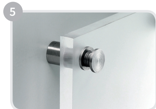
5 Kopfteil mit Linksgewinde (Vandalismusschutz) einschrauben.
